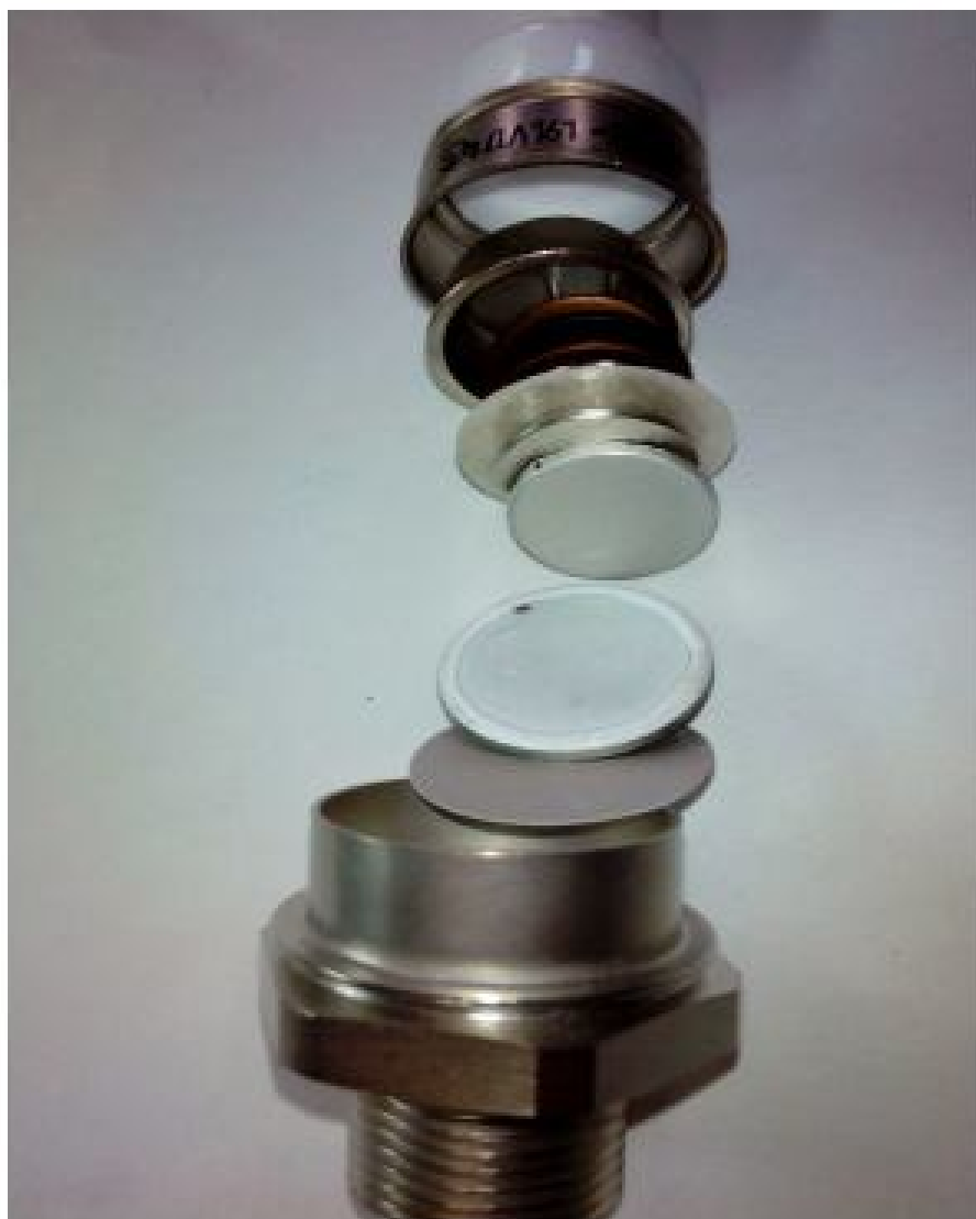
Рисунок 2 – Реальний вигляд приладу притискної конструкції на прикладі ДЛ161
