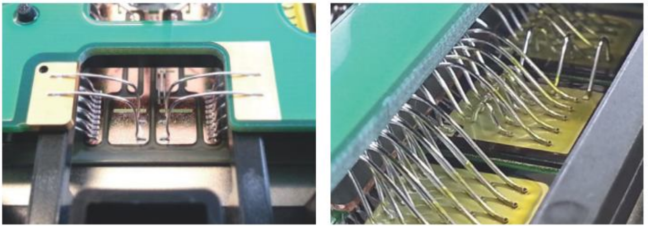
Рисунок 6 – Приклад виконання з'єднання за технологією Wire bonding.
