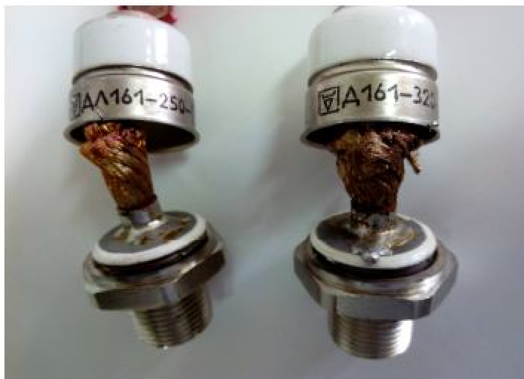
Рисунок 4 – Реальний вигляд приладу паяної конструкції на прикладі ДЛ161
